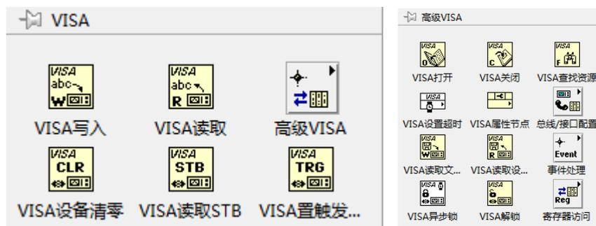
串口在进行通信前，需先为 VISA 配置串口，波特率和数据比特使用默认值即可。配置串口后即可写入数据，使用 VISA 写入函数，将写入缓冲区的数据写入 VISA 资源名称指定的设备或接口中。整个 WHILE 结束之后再关闭 VISA。
