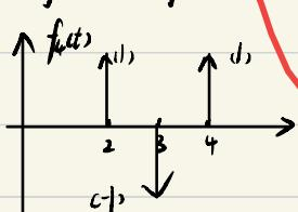
$$\begin{aligned} f_1(t) * f_4(t) &= f_1(t) * (\delta(t-2) - \delta(t-3) + \delta(t-4)) \\ &= f(t-2) - f(t-3) + f(t-4) \end{aligned}$$
