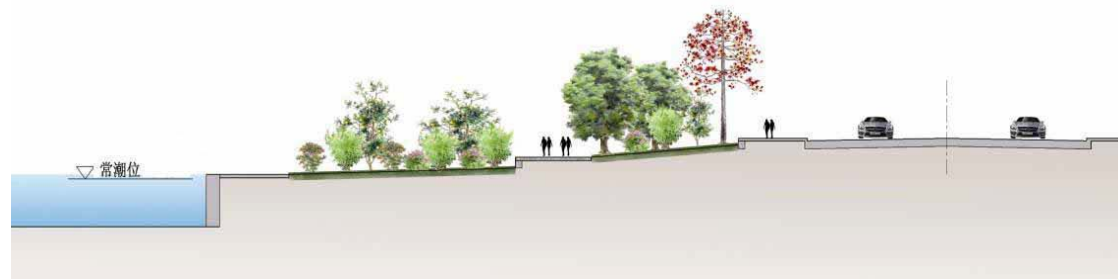
图 8-11 复合式堤防断面示意图
