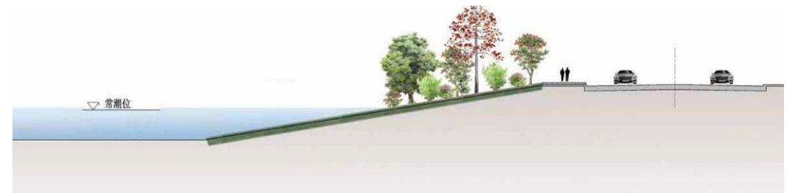
图 8-9 斜坡式堤防断面示意图
