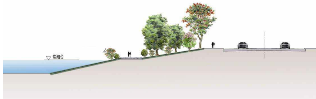
图 8-10 多级斜坡式堤防断面示意图
