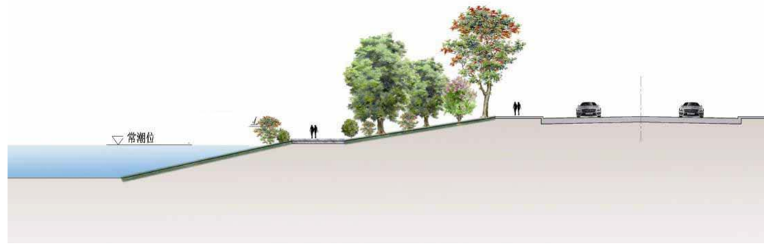
图 5-12 多级斜坡式堤防断面示意图
