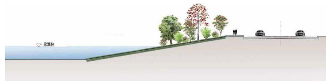
图 5-11 斜坡式堤防断面示意图
