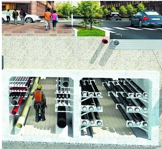
图 12-5 综合管廊断面示意图（右侧为电力仓）
