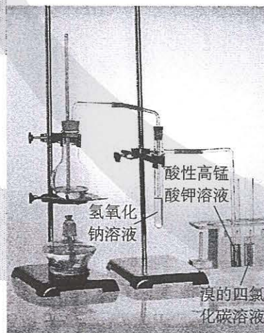
图3-9 乙醇的消去反应
