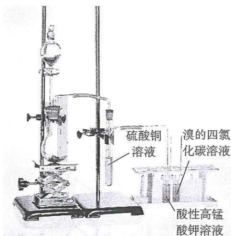
图2-6 乙炔的实验室制取及性质检验
