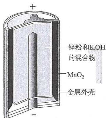
图4-3 碱性锌锰电池的构造示意图
