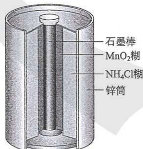
普通锌锰电池构造示意图
