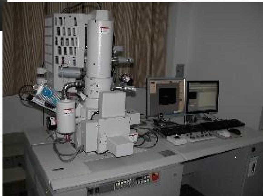
JSM-7800F-Prime-场发射扫描电子显微镜 (SEM)
