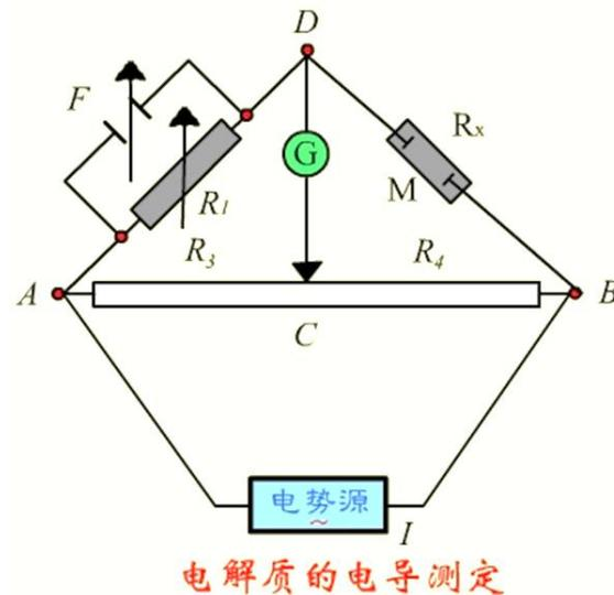
将对溶液电导的测量转换为对回路电阻的测量
