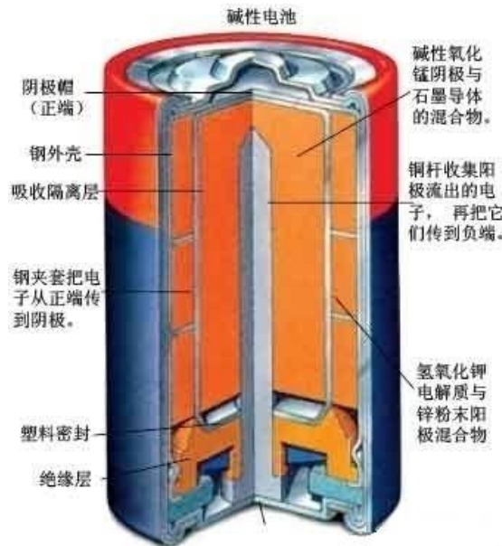
图 6.4 高能碱性电池的结构图
