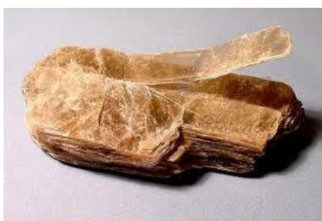
图 3 石墨的电阻率、云母的解理，都是晶体物理性质各向异性的最好表现。
