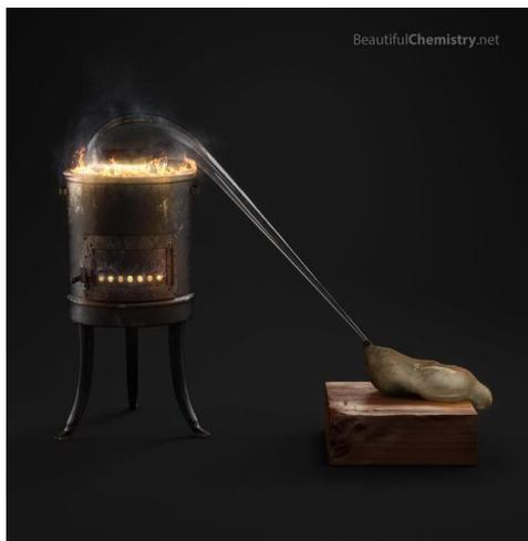
上图展示的是著名化学家卡尔·威廉·舍勒（Carl Wilhelm Scheele）1777年的著作《论空气和火的化学》（*Chemische Abhandlung von der Luft und dem Feuer*）中用于制备氧气的装置。装置中的曲颈瓶中装有硝酸钾与浓硫酸的混合物，在火炉加热下释放出一种无色气体，被固定在曲颈瓶瓶口用动物膀胱做成的口袋收集。他对这种气体的性质作了研究，发现它可以帮助燃烧，所以他把这种气体叫做“火气”，并且通过硫肝（主要成分是硫化钾和多硫化钾）对氧气的吸收和白磷在氧气中燃烧，测出了“火气”占空气体积的约五分之一，实际上这种火气就是氧气。
