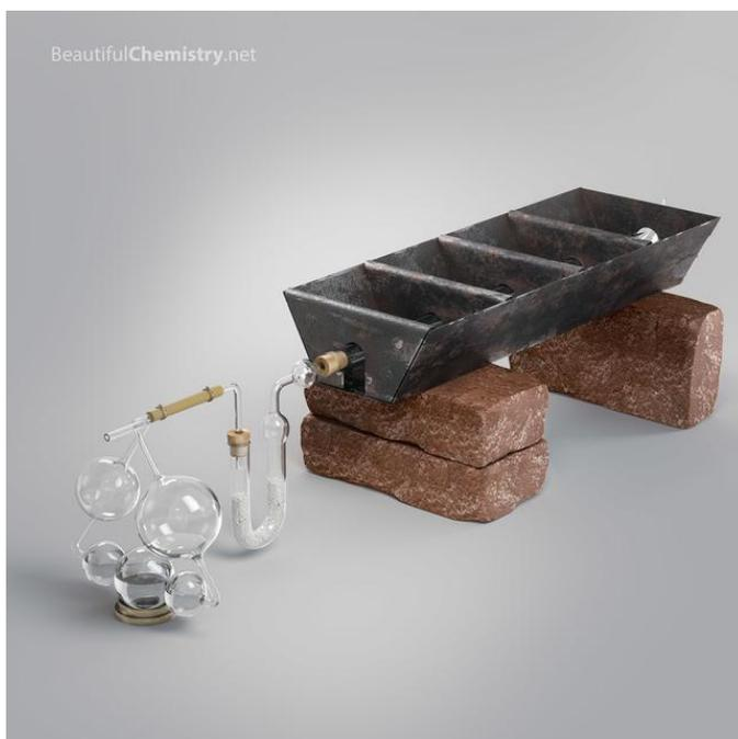
上图展示的是德国化学家李比希 1837 年的著作《有机物分析》（*Anleitung zur Analyse Organischer Körper*）中用于测量有机物中碳、氢、氧含量的元素分析的实验装置。李比希提出，由各种元素含量推知元素结构，从而得出化学式。
