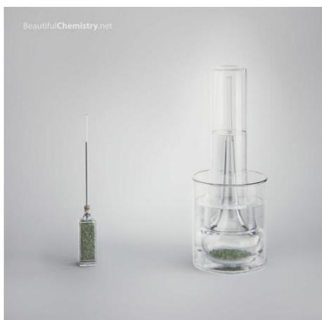
上图展示的是植物生理学和空气化学专家斯蒂芬·黑尔斯(Stephen Hales)1727 年的著作《植物静力学》(*Vegetable Staticks*)中通过发酵方法制备和收集气体的实验装置(复原图)。可以通过倒立容器中水位的变化确定绿豆等被测物在发酵过程中产生气体的体积。
