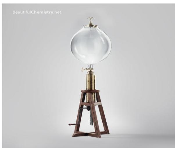
上图展示的是著名化学家罗伯特·波义耳（ Robert Boyle） 1660 年的著作《关于空气弹性及其效应的物理—力学新实验》（*New Experiments Physico-Mechanical, Touching the Spring of the Air, and Its Effects*）中的真空泵（复原图）。它能使观察者看到玻璃试管内部的情况，并允许人们引导甚至控制实验的发展。波义耳通过这台真空泵进行了很多有关空气属性的实验。
