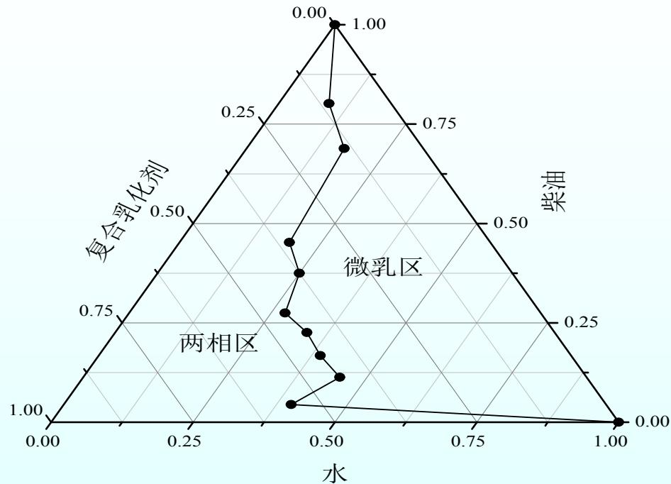
通过绘制的“微乳柴油、水、复合乳化剂”拟三元相图，观察与分析实验条件下可形成微乳柴油的组成区域与条件。
