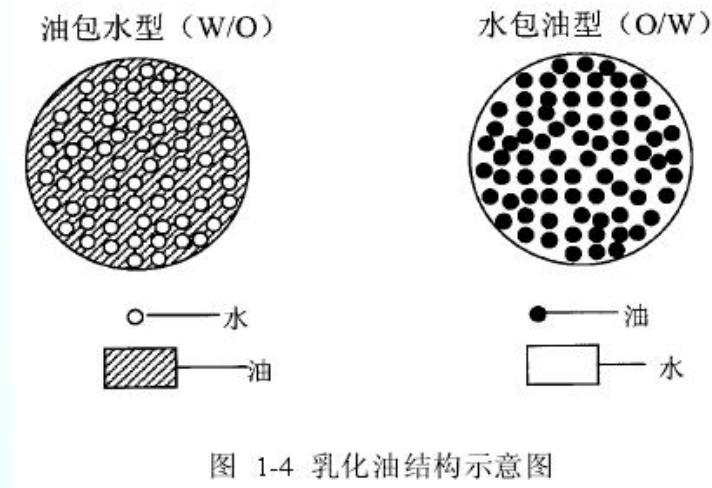
图 1-4 乳化油结构示意图
