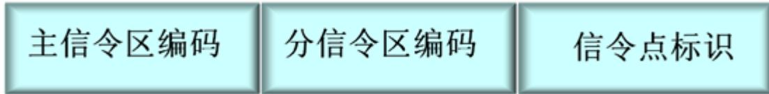
我国信令网信令区的划分与我国信令网的三级结构相对应，分为主信令区、分信令区、信令点三级，这样 HSTP 设在主信令区，LSTP 设在分信令区。我国的信令网划分为 33 个主信令区，每个主信令区又划分为若干个分信令区。主信令区按中央直辖市、省和自治区设置。一个主信令区内一般只设置一对 HSTP。
