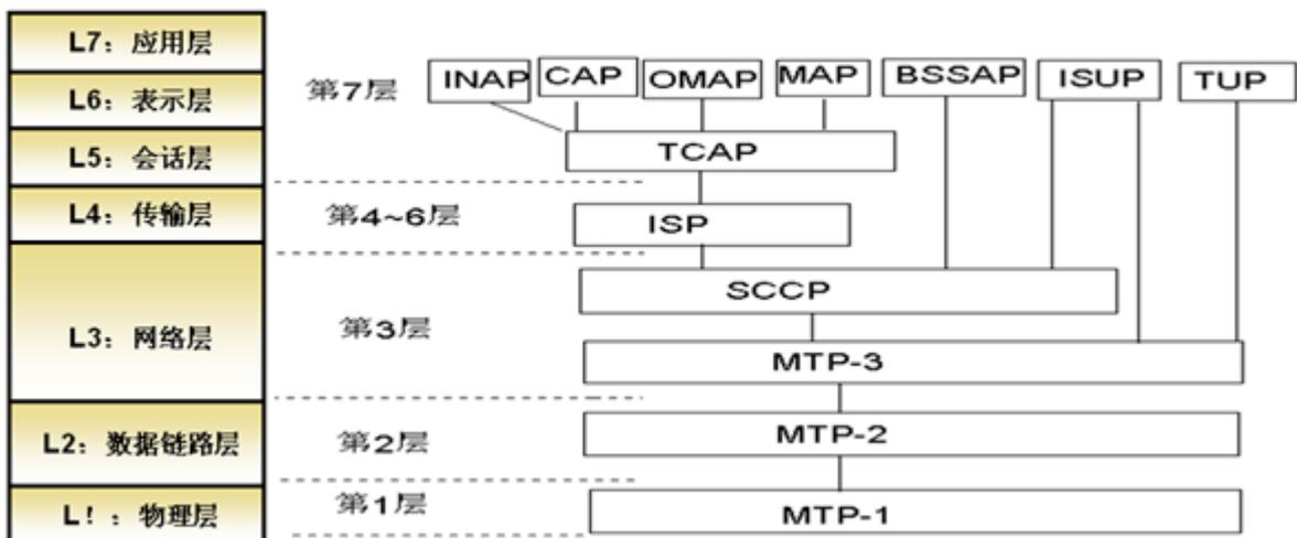
INAP: 智能网应用部分 OMAP: 操作维护应用部分 CAP: CAMEL 应用部分 MAP: 移动应用部分 TCAP: 事务处理能力应用部分 BSSAP: 基站子系统应用部分 ISUP: ISDN 用户部分 TUP: 电话用户部分 SCCP: 信令连接控制部分 MTP: 消息传递 ISP: 中间服务部分
