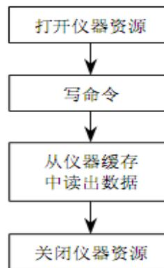
图 2: VISA 仪器控制流程
